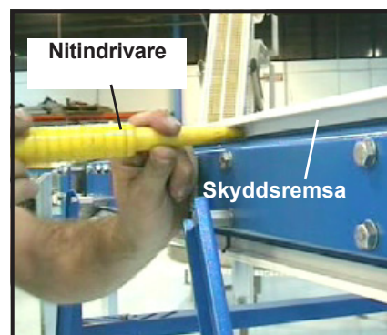
Figur 17: Nita fast skyddsremсор
