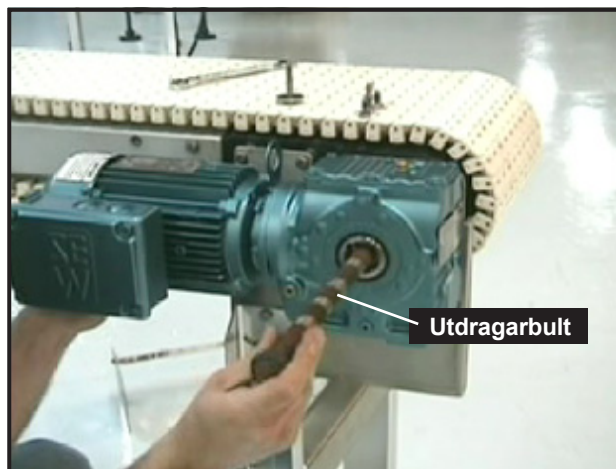
Figur 43: Sätt in utdragarbulten för att lossa drivhuset från axeln
