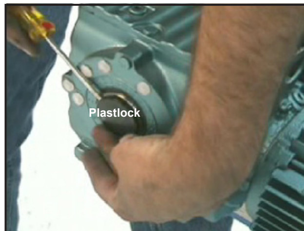
Figur 40: Ta bort plastskyddet
