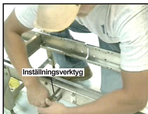
Figur 6: Använd inställningsverktyget (i det tomma hålet) för att dra
