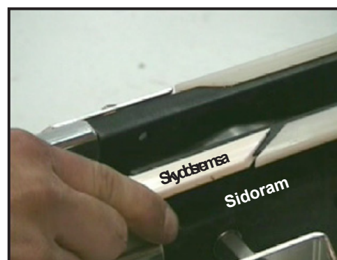
Figur 14: För in skyddsremсор i sidoramen
