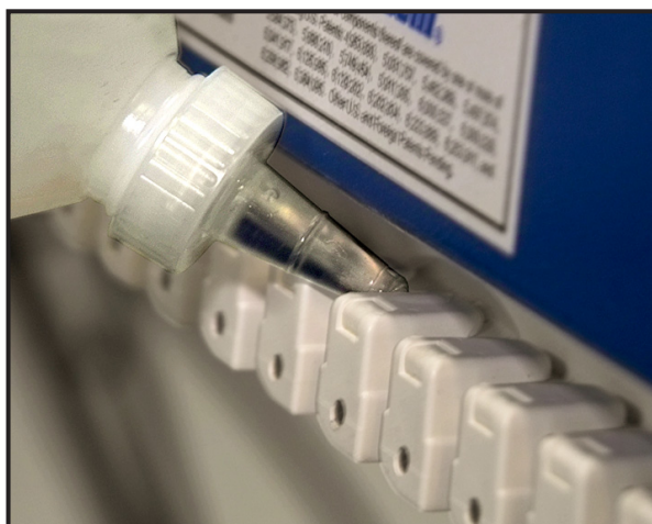
Smörj in bandtransportörens skyddsremor med silikonolja
