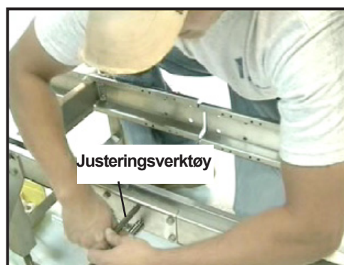
Bilde 6: Bruk tilpasningsverktøy (i åpent hull) for å dra bunndelene
