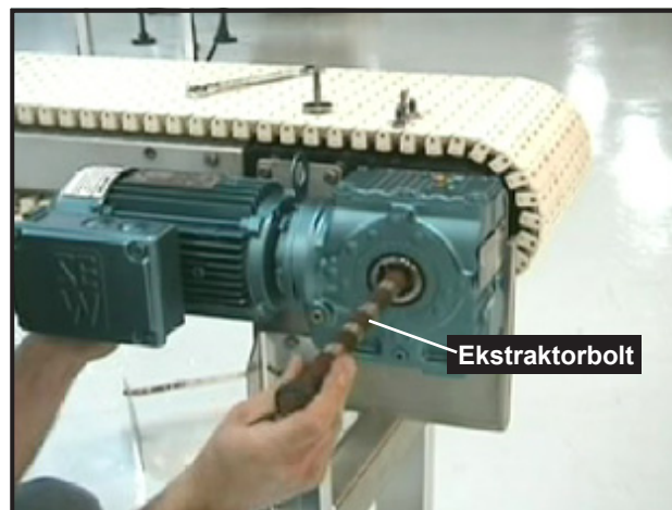
Bilde 43: Sett inn ekstraktorbolt for å drive girkasse av aksel
