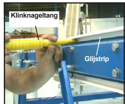
Figuur 17: Steek klinknagel in om glijstrip vast te zetten
