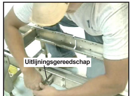
Figuur 6: Gebruik uitlijningsleutel (in opening) om lopende bandsecties samen te trekken
