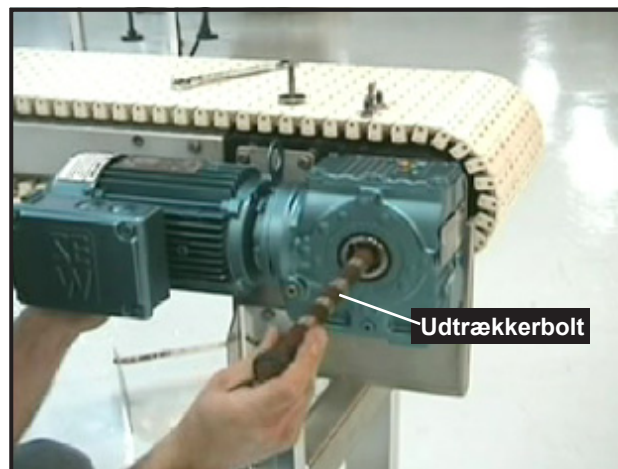
Figur 43: Indsæt udtrækkerbolten for at tvinge gearkassen af akslen
